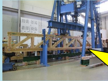
スギ心去り梁材の曲げ強度試験
