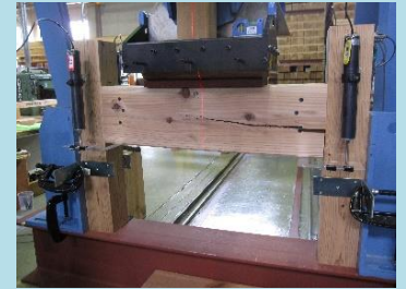
金物接合部の性能試験（柱－梁）
