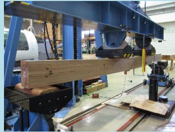
スギ心去り梁材の曲げ強度試験
