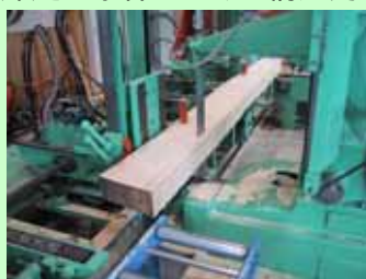
写真 - 2 梁・桁材への製材の様子
