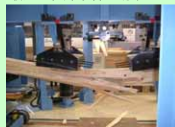
写真 - 4 実大強度試験機による破壊試験の様子
