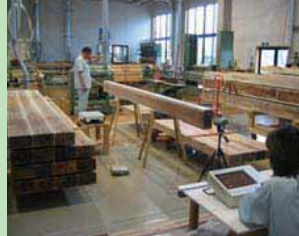
写真2 縦振動法による動的ヤング係数の測定
