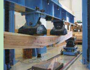
写真3 実大曲げ破壊試験
