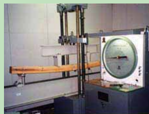
写真2 スギ正角の曲げ破壊試験
