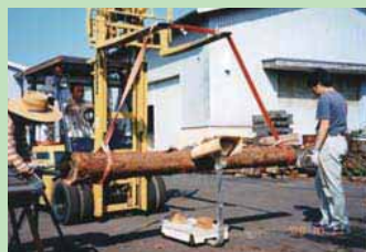
写真1 縦振動法による E_{fr} 測定
