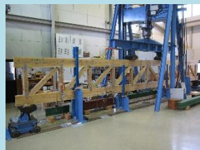
実大性能確認のための曲げ試験
