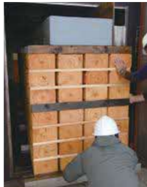
ヒノキ心持ち横架材の人工乾燥
