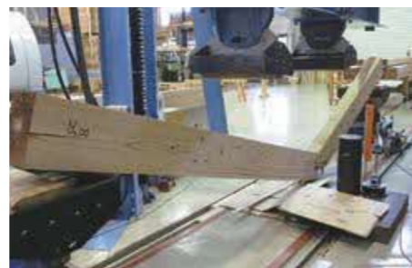
製材・乾燥試験を行った材の実大曲げ強度試験
