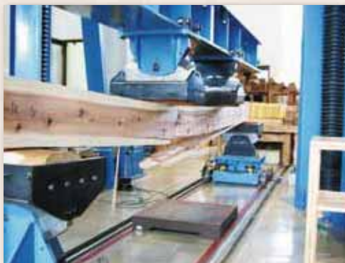
■スギ製材品の強度試験
