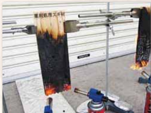
■スギ準不燃材料の燃焼試験
