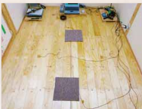
■床暖房にも使えるクロマツフローリングの評価試験
