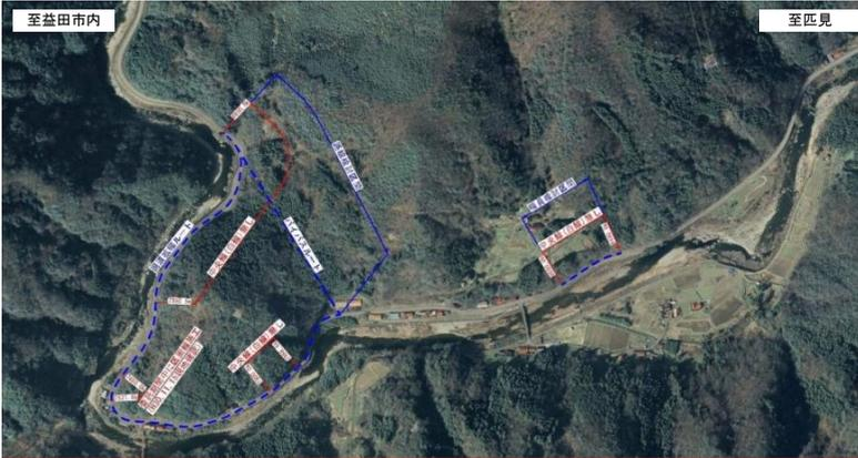
路線比較検討は、①トンネル案、②第3種第3級の道路規格を満足した現道拡幅案、③地域に応じた弾力的な基準運用(道路構造令P.64)による現道拡幅案により行った。③は、現道のルート検討区間において、現在2車線で運用している区間と1車線で運用している区間が点在しているため、1車線区間に着目して改良を行い、早期の2車線運用を図るものである。
