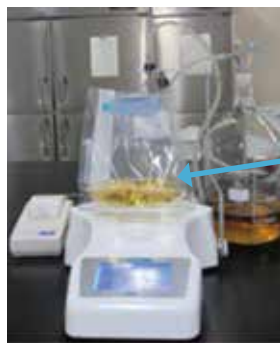
自動秤量希積分注装置 自動的に希釈液を入れて食品検体を10倍量にする装置
