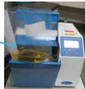
ストマッカー 袋の外からたたきつぶしながら食品検体を均一にする装置
