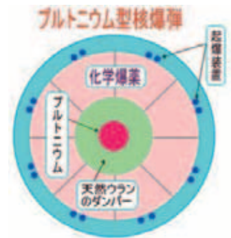
図3 プルトニウム型核爆弾の断面図
