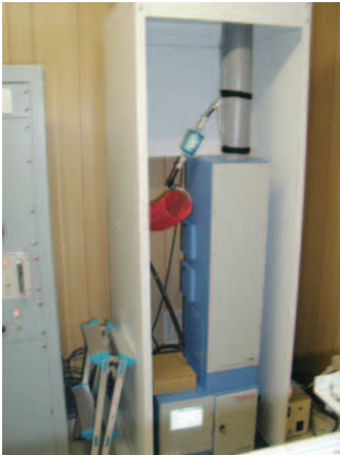
図1 大気汚染監視用PM2.5-PM10粒子状物質濃度測定装置 (国設松江大気環境測定所、大気中の粉塵は上図の捕集装置から下図の分析装置に導入されます。)
