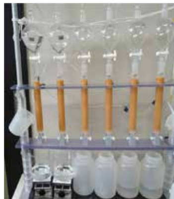
前処理した試料溶液を陽イオン交換樹脂に通してストロンチウムを単離している様子
