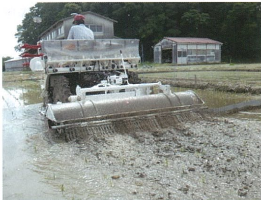
図2 チェーン除草器具を取り付けた水田用除草機による機械除草
