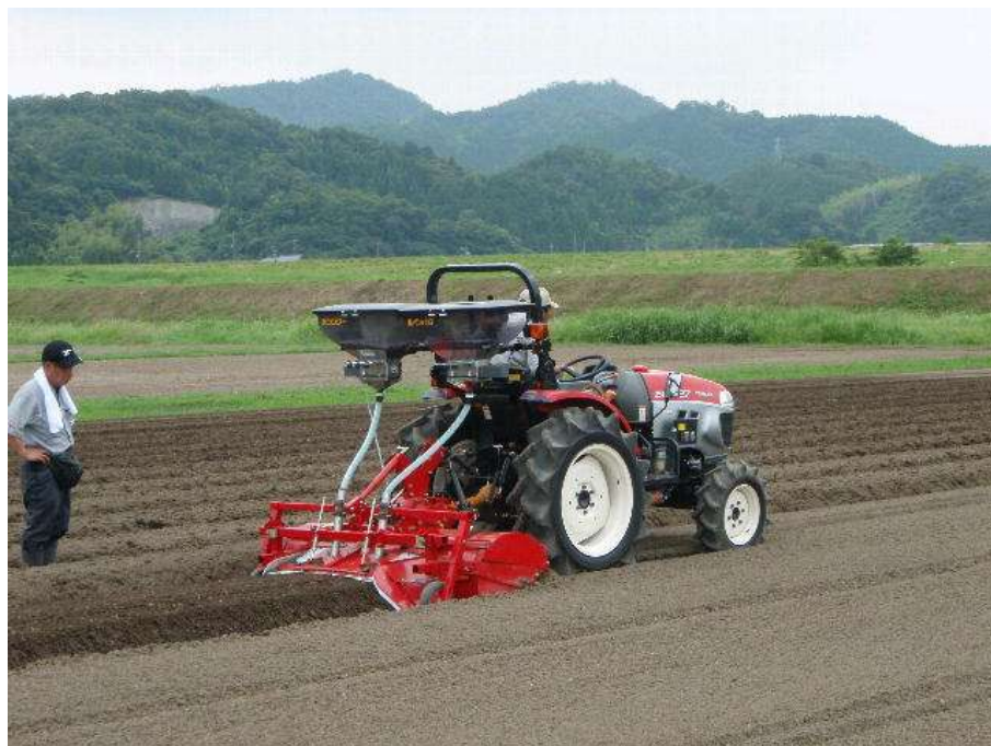
畝たて同時施肥機の実演風景 (東部農林振興センター中海干拓営農部実証ほ場)
