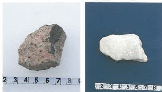
銀鉱石から銀を取り出すための添加物（右が鉛片、左が酸化マンガングル）。江戸時代前半の技術が、発掘調査と科学調査により少しずつ判明し始めています。
