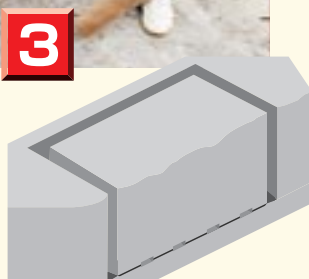
4 矢を打ち込む穴を掘る
