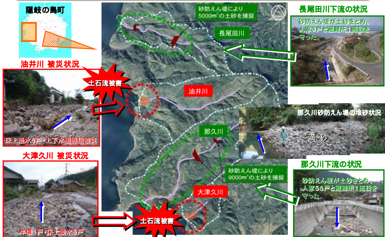
平成 19 年 8 月豪雨における土石流災害 （隠岐の島町）と砂防施設の効果事例
