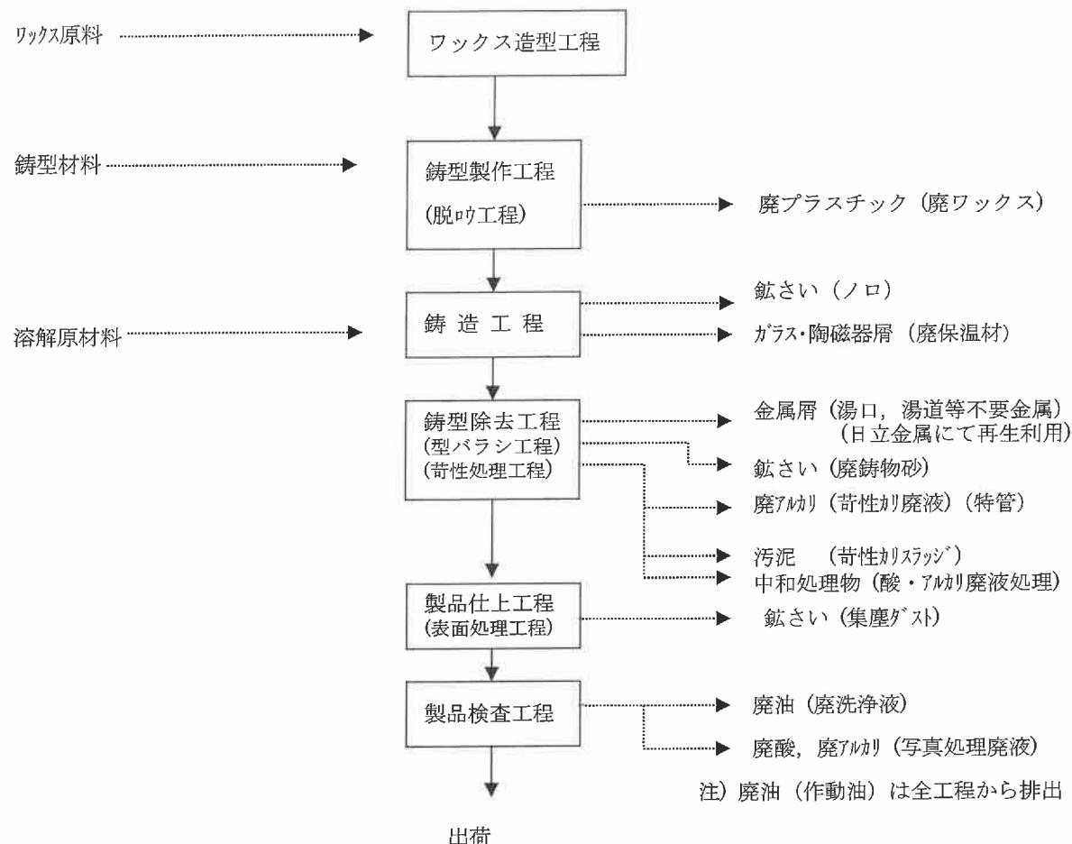
図1 精密鋳造品製造フローシート
