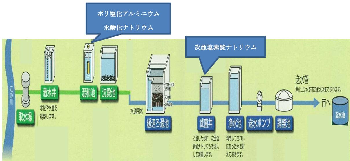
※今津浄水場と三代浄水場は河床下の伏流水を取水しています。このため、今津浄水場には取水場、混和池、沈殿池が、三代浄水場には混和池、沈殿池がありません。
