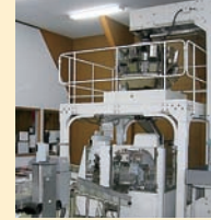
乾物製造全自動充填ライン
