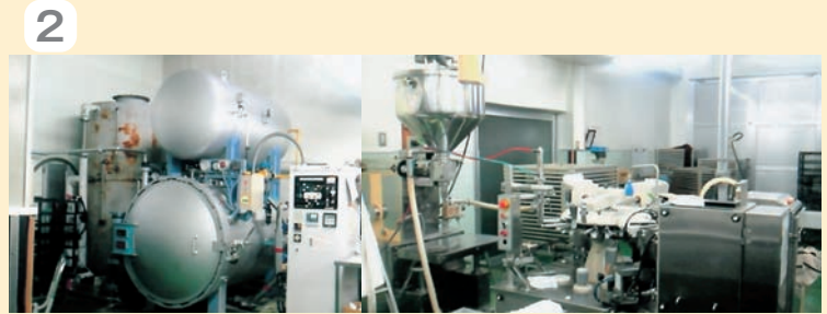
1.各種レトルト食品 2.(左)レトルト殺菌釜、(右)自動充填機
