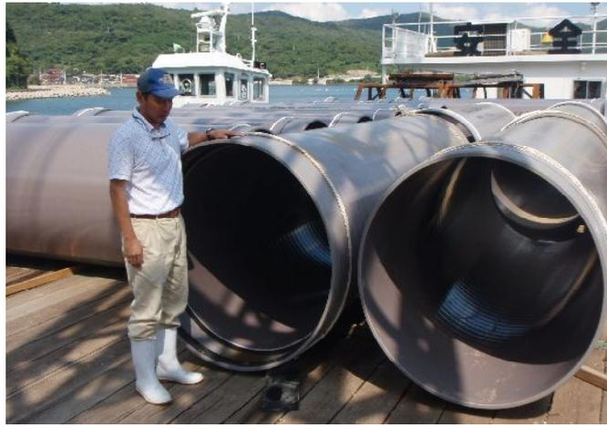
海底に埋設される直径 1.2m の取水管 (FRPM 製)
