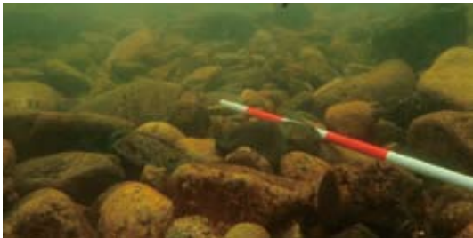
図6. 谷住郷の瀬の図3中の地点⑥の河床. 礫径2-10cm主体で, 貫入度は平均12cmで, アユの産卵場として適していると考えられた.
