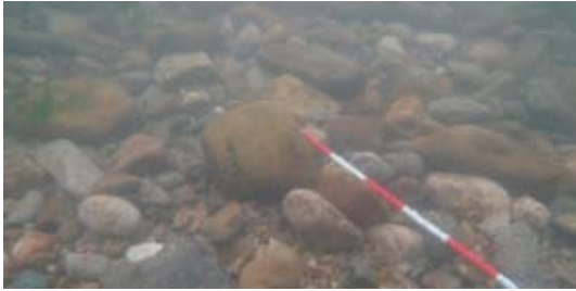
図5. 谷住郷の瀬の図3中の地点⑩の河床. 礫径は1-5cm主体, 最大礫径は15cmで, 貫入度は20cm以上の浮き石状態に若干の砂が混じり, アユの産卵場として適していると考えられた.
