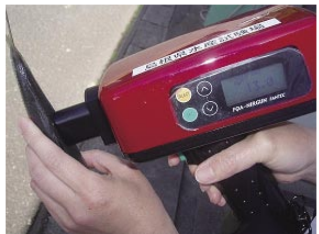
写真1 測定に用いたポータブル型近赤外分光分析装置
