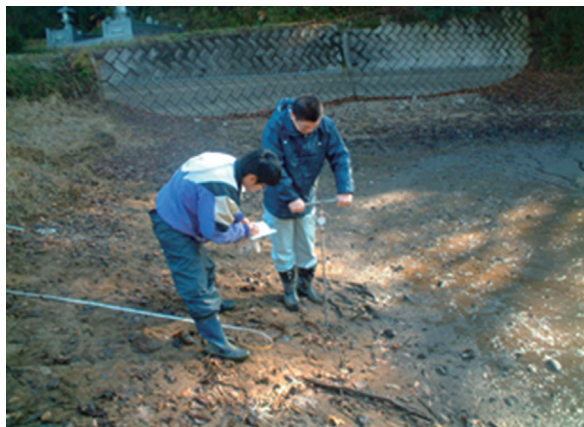
コーンペネトロメータによる地耐力及びへドロ厚測定
