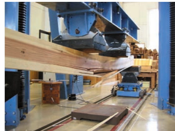
鳥根県中山間地域研究センター による木材の曲げ強度試験
