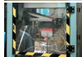
上段：杉トラスの曲げ強度試験
