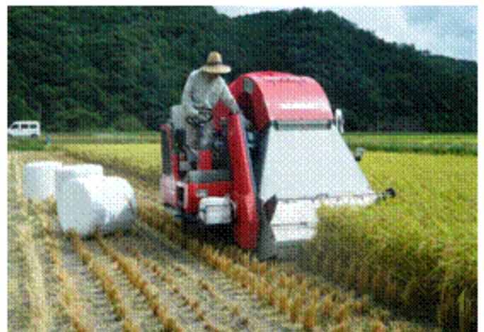
図3 フレール型収穫機
