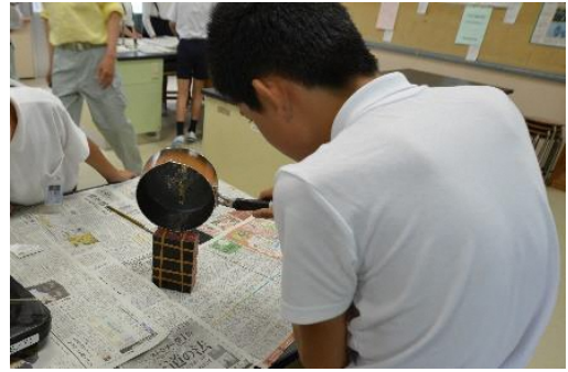
溶けた金属を鑄型に流し込みます。
