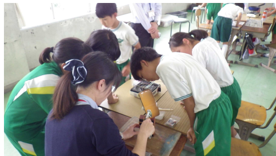
「溶かした金属を鋳型に流し込みます。」
