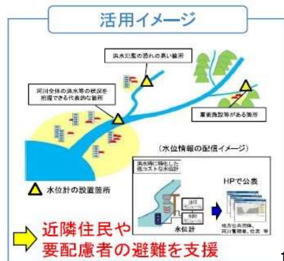
洪水に特化した低コストな水位計の設置例
