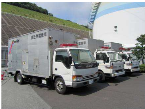
[写真] 高圧発電機車
