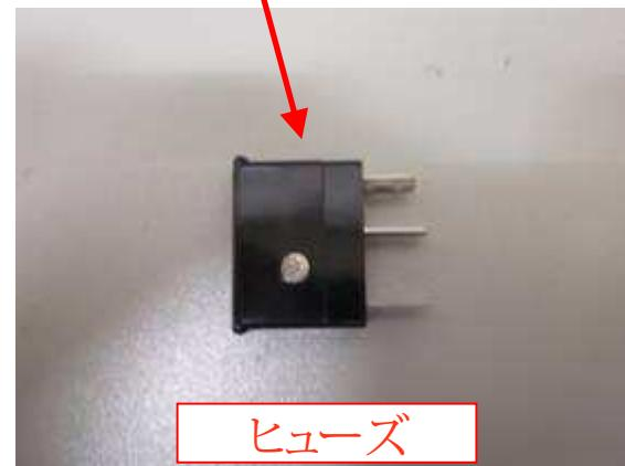
設置目的：ヒューズは、過電流から機器を保護する目的で設置している。
