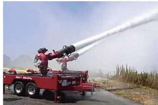
大容量泡放水砲システムによる放水訓練 (大阪・和歌山広域共同防災協議会)
