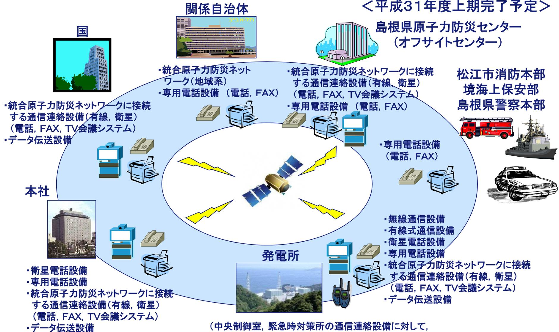
(中央制御室, 緊急時対策所の通信連絡設備に対して, 非常用所内電源に接続し, 代替電源設備を設ける)
