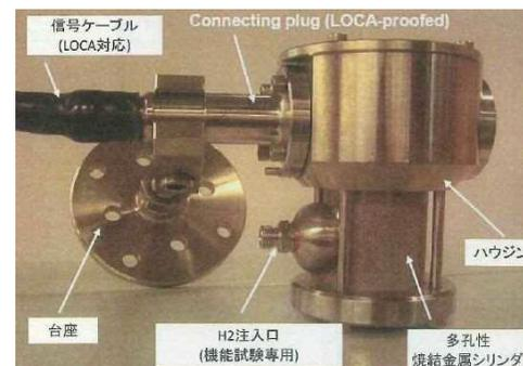
■ : 静的触媒式水素処理装置
