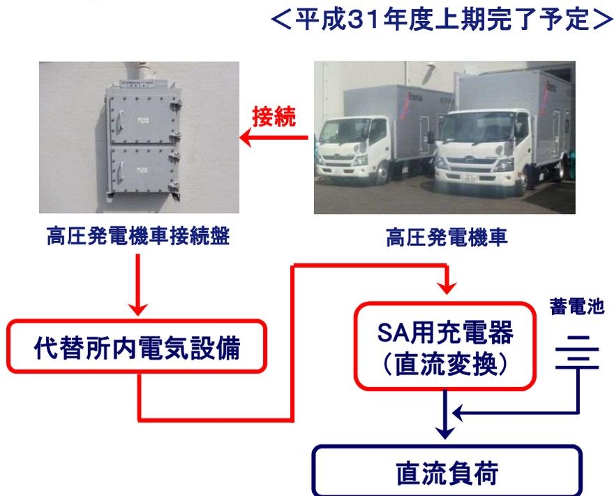
(注)可搬型直流電源設備として、高圧発電機車と組み合わせて使用する直流給電車を自主対策設備として配備する。
