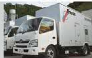
高圧発電機車
