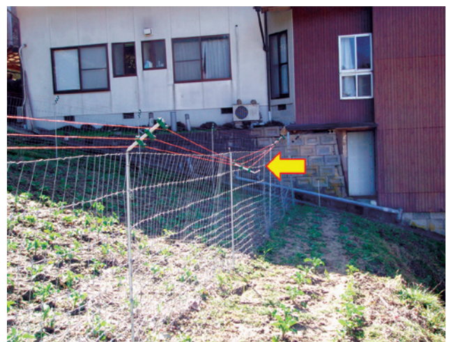
写真6 電気ショックを受けた衝撃によって外れた 忍び返しの支柱 (試験地5)
