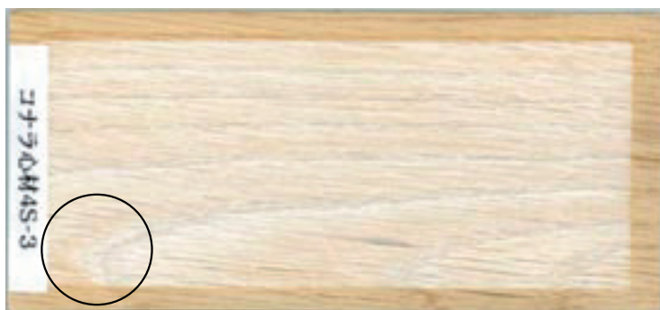
写真3 促進劣化処理500時間目のコナラ心材ひき板 (左：コナラ心材ひき板，右：写真左の丸印部分の拡大，PZ：孔圏（早材）部分， C：促進劣化処理により発生した孔圏外（晩材）部分の割れ)
