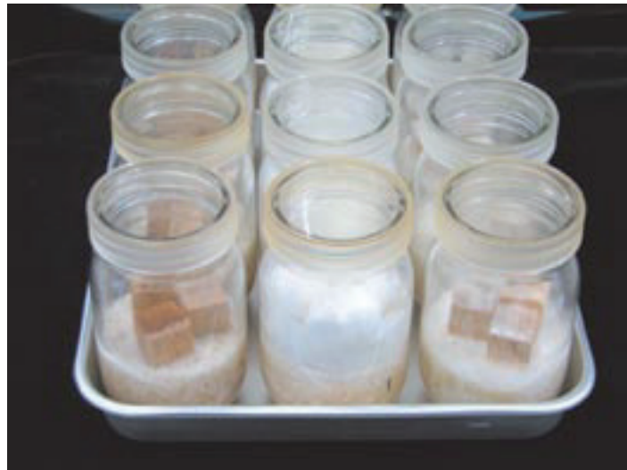
写真1 腐朽操作15日目のコナラ心材試験体 (左：補正試験体，中央：オオウズラタケ，右：カワラタケ)
