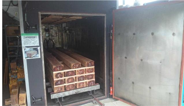
高温セットから中温乾燥までを**蒸気式高温乾燥機1機**で
