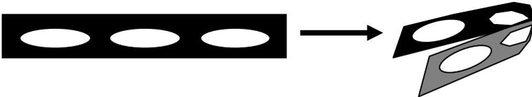
折り曲げたフラットバーを本体内側からワイヤーメッシュの鋼線を挟むように入れます。さらに、折り曲げたフラットバーの一方をゲート支柱の穴に差し込み、ボルトで留めます(下図参照)。
