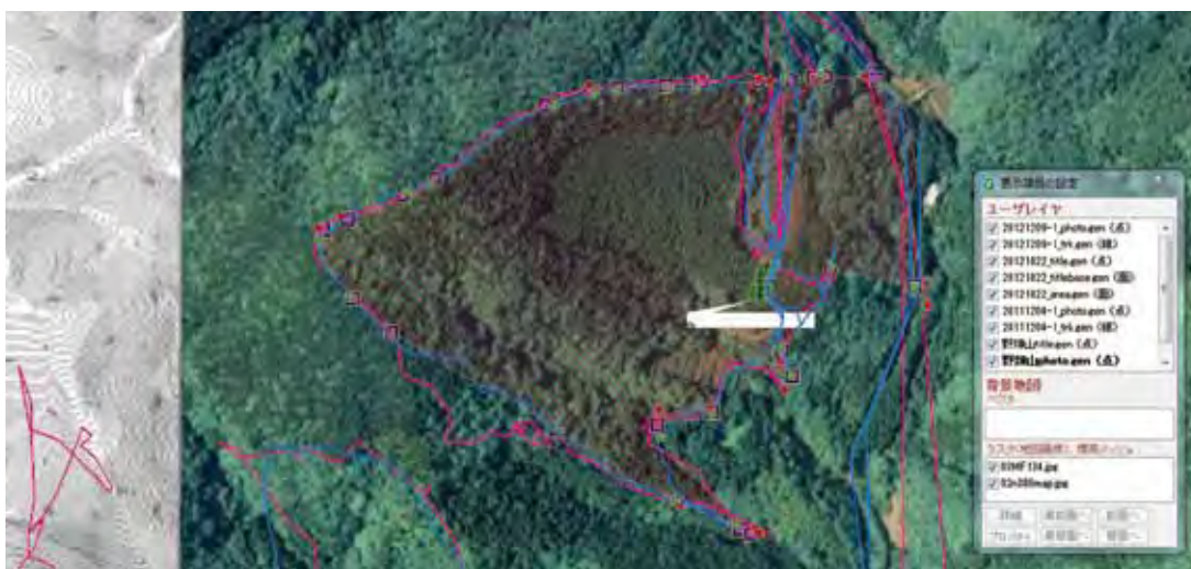
管理している山林の境界杭の位置をGPSで取得し、GISソフト「地図太郎」を使用して読み込み、マップを作成。
