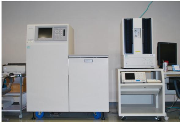
図2 液体シンチレーションカウンタ（左： $^3\text{H}$ の測定で使用）
